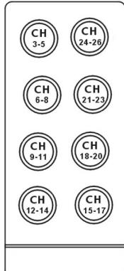
Die Dimmer-Funktion besetzt den ersten Kanal, die Flash-Funktion besetzt den zweiten Kanal, jeder Spot besetzt 3 Kanäle.
